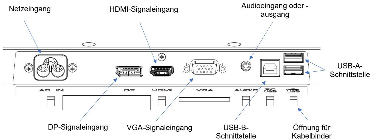
Hinweis: Die Öffnung für den Kabelbinder ist die Öffnung, durch die Sie den Kabelbinder zum Festziehen des Kabels führen können. Sie müssen lediglich den Kabelbinder durch die Öffnung stecken und das Kabel zur Fixierung der Kabelverbindung festziehen.
